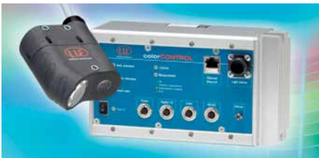
Bild 1. Das Online-Farbmesssystem identifiziert die Farbe über das Reflexionsspektrum.
