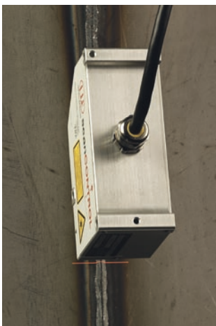
Profilschanner Scancontrol zur Qualitätsprüfung von Schweißnähten.
