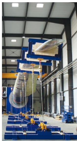
Links: Das 56,5 Meter lange Rotorblatt MB5000 von Multibrid ist hier in den Prüfstand montiert.
