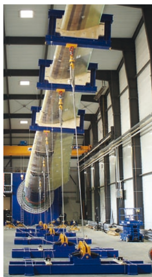
Links: Das 56,5 Meter lange Rotorblatt MB5000 von Multibrid ist hier in den Prüfstand montiert.
