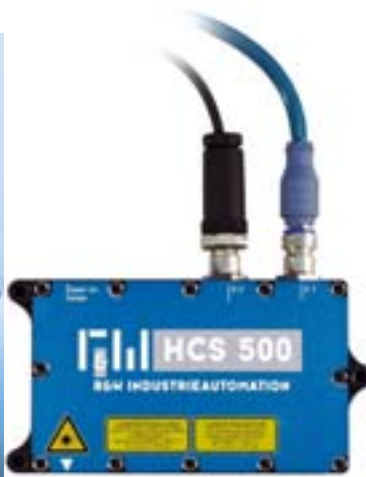
Der modifizierte Sensor von R&W mit eigenem Label und Ethernet-Interface
