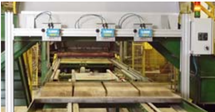
Per Triangulation messen die Sensoren senkrecht auf die Brettförderer
