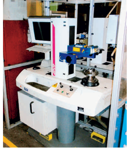
Mit dieser Anlage werden Synchronringe halbautomatisch und hochpräzise vermessen.
