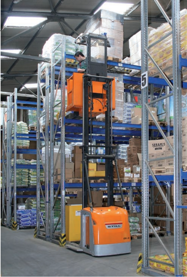
In Kommissionierstapler messen Seilzugsensoren die Höhe der Gabel und ermöglichen damit indirekt eine schnellere Logistik
