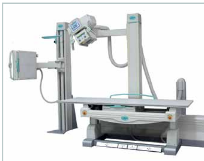
An verschiedenen Positionen von digitalen Röntgenanlagen erfassen Seilzugsensoren die aktuelle Position. So werden Bildaufnehmer und Röntgenröhre aneinander ausgerichtet
