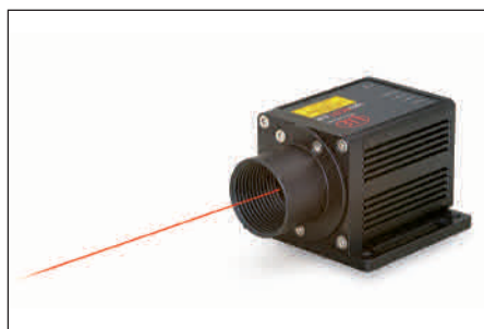
▲ Die optoNCDT ILR2250 Laser-Distanzsensoren nutzen das Phasenvergleichsverfahren und erfassen Messobjekte auf Distanzen von 0,05 m bis zu 150 m mit höchster Signalstabilität.
