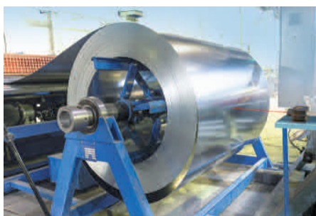
▲ Eine kontinuierliche Erfassung des Coil-Durchmessers ist notwendig, um den Prozess des Abwickelns genau zu überwachen und den Wechselzeitpunkt des Coils frühzeitig bestimmen zu können. Laser-Distanz-Sensoren der Reihe optoNCDT ILR2250-100 von Micro-Epsilon übernehmen diese Aufgabe.
