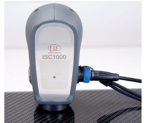
▲ Dank innovativer Technik auf Mikrowellenbasis misst das ISC1000 die Gesamtschichtdicke isolierender Materialien auf CFK und Metallsubstraten zerstörungsfrei und ohne Koppelmedium.
